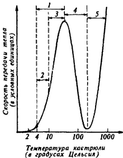
Рис. 1. Кривая кипения для воды. 1 — пузырьчатое кипение, 2 — изолированные пузырьки, 3 — столбы и «куски» пара, 4 — переходный режим кипения, 5 — пленочное кипение.
