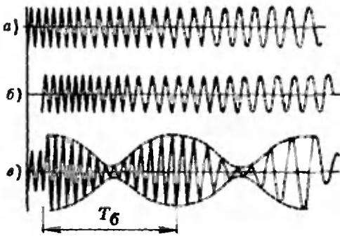
Рис. 3. Суммирование колебаний плавно изменяющихся частот: а) первый импульс; б) второй импульс; в) результат сложения.
